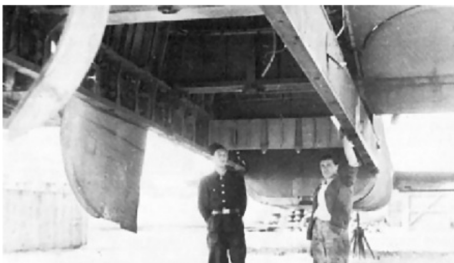
La enorme bahía de bombas especial para contener a Hagen. Foto realizada tras el final de la guerra en letov, 1945 (foto Griehl)
