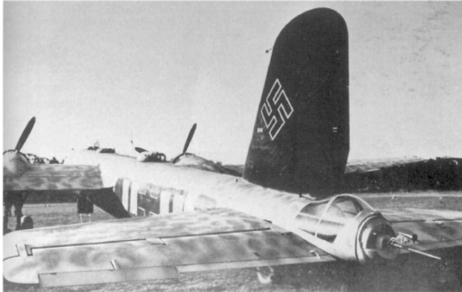
«Berliner Luft» antes de haberse realizado los cambios de armamento de a bordo. Puede verse la torreta trasera original, destinada a un artillero y que fue cambiada por dos cañones gemelos MK108Z de 30 mm cada uno
