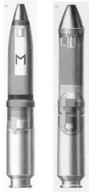
El cañón Rheinmetall-Borsig MK-108 de 30mm. Abajo plano del cañón y munición empleada: explosiva (izquierda) e incendiaria (derecha)
